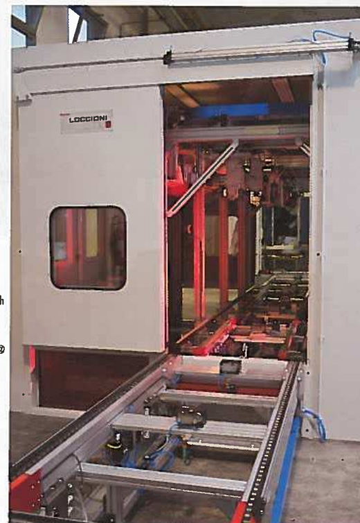
Una camera acusticamente isolata per verificare la qualità dell'assemblaggio in linea con l'ausilio di vibrometri e microfoni.
