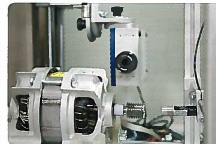
Figura 3: Amber, particolare della sezione prove vibrazionali e acustiche
