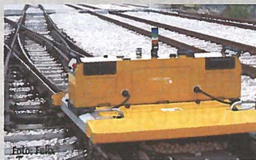
Felix® ist in der Lage, Weichen und Gleise automatisch zu untersuchen. Foto: Loccioni
